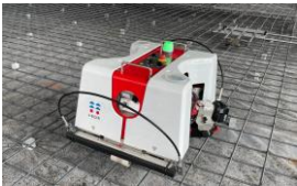
2 建ロボテックが開発・販売する「鉄筋結束ロボット」
