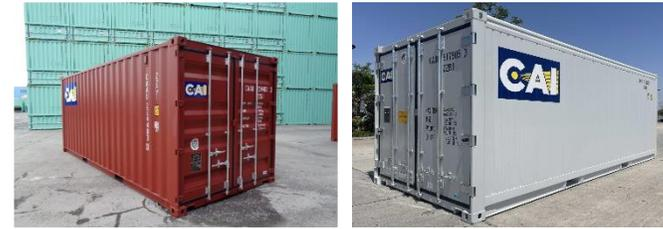
▲ 海上コンテナ(左:ドライコンテナ、右:リーファー(冷蔵)コンテナ)
