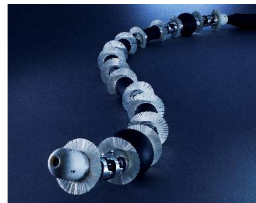
📷4 ソラリスが提供するミミズ型管内走行ロボット「Sooha」
